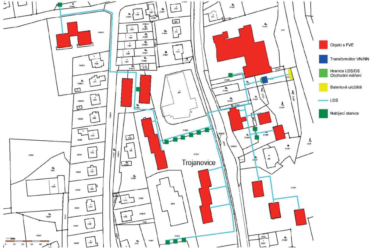
Schéma plánované lokální distribuční soustavy obce Trojanovice
